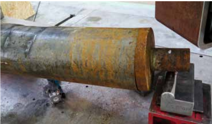
Efter slagning enligt ASTM 4945 testas bergskon i böj.
