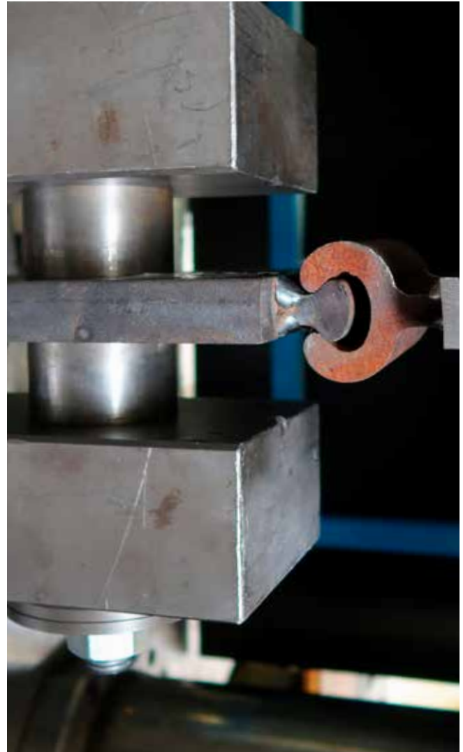
Böj och dragprov utfört på RISE (SP Sveriges Tekniska Forskningsinstitut) i Borås.
